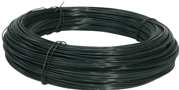
Fil de fer plastifié , en rouleau, avec un poids de 30 kg, BWG n° 12/8, avec un diamètre interne (fil) de ±2,77 mm et un diamètre externe de 4,19 mm (avec revêtement plastique).
