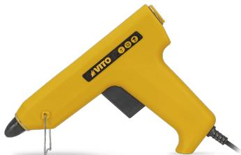
Pistola de encolar con una potencia de 40 W, tiene una temperatura de trabajo de 170°C y un corto período de calentamiento de 5 min., barras de pegamento termofusible con un diámetro de 10 mm, incluye además 2 barras.
